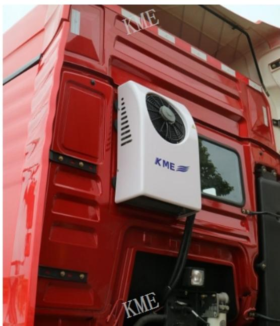
KME车用全直流变频空调，调温范围为18°C-28°C。主打功能节能、轻量、静音。首先是超大扇热叶片，加强了空气对流使散热效果更加明显。其次是多芯美标电源线，可以抗击大电流，与普通电源线比更安全可靠。其次是车规级耐腐浊防松螺栓，经久耐用持久如新，不用担心螺栓生锈老化，也不用担心随着车子振动而影响到螺栓松动。再是性能高的压缩机，具有强而有劲的动力。另外是智能控制模块，智能节能控制技术，防水防尘设计。使用KME车用全直流变频空调，减少发动机的怠速时间，还可以有效减缓发动机和其他零件的磨损，可节省保养费用。KME车用全直流变频空调行车、驻车过程中均可使用，如果行车中代替原车空调使用百公里可节省2-3L燃油。KME车用全直流变频空调，用户的信赖之选，欢迎您的来电！广东24V顶置式卡车空调值得推
